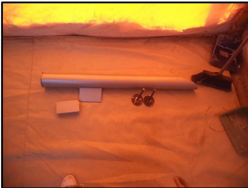
Figura 3: Soporte tipo Trunnion. SP-07 de la lista de soportes
